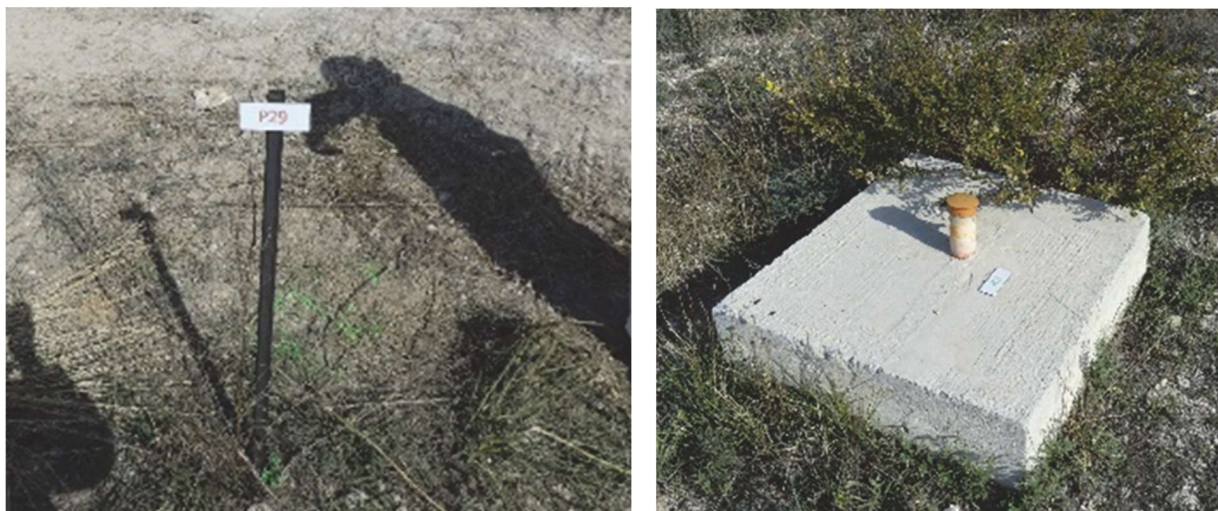
Illustration 31 : Photographies de l'étiquetage d'un pieu du flanc Ouest et d'un piézomètre (novembre 2022).
