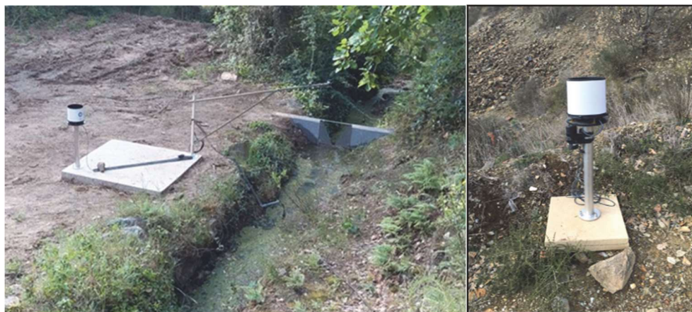
Illustration 178 : Station hydrométrique sur l'Entrebusc, verse de l'Atelier (mai 2022) et pluviomètre déplacé (novembre 2022).
