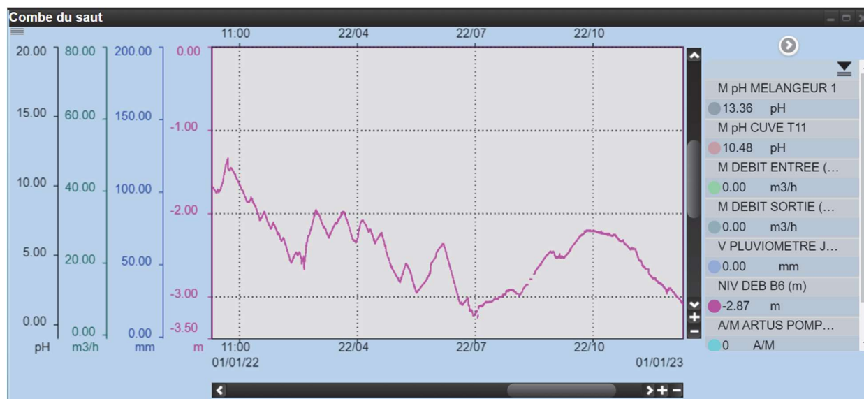
Illustration 111 : Capture écran supervision DPSM : Suivi du niveau du bassin B6 de l'Artus (source : Logiciel TOPKAPI).
